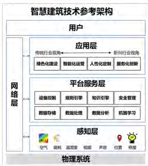
图8 智慧建筑技术参考架构
