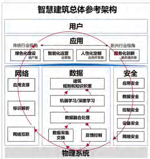
图7 智慧建筑总体参考架构
